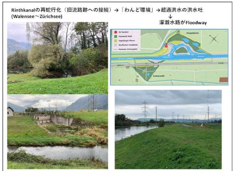
それから、アーレ川はヌシャテルの3湖に近づいたところでかつては非常に蛇行していて沿川の町がしょっちゅう氾濫していたのを1次改修時にその手前で直線水路でビール湖に抜いて（捷水路）安全を確保、さらにアーレ川の流量をビール湖の水位の調整によって洪水調節。加えてヌシャテル湖、ムルテン湖ともつなぐことによって、この3湖で下流のアーレ川、さらにはライン川の洪水を見ながら洪水流況調整をしています。旧アーレ川沿いには集落があったために新水路が建設されたが、新水路沿いは農地ということで、最近になってこの部分で乗り越し堤整備をやっていました。
