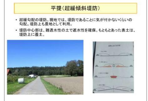
このような幅の広い緩勾配の堤防でも、堤防中心部は、難透水性の土で遮水性を確保しています。もともとあった表土は、堤防上に覆土し、堤防上も農地として利用しています。この場合、洪水の継続時間が長いので、堤防の土質管理をしっかりやっています。
