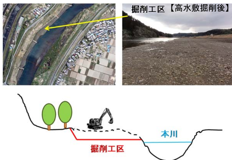
図-1 河道掘削（高水敷掘削）のイメージ
