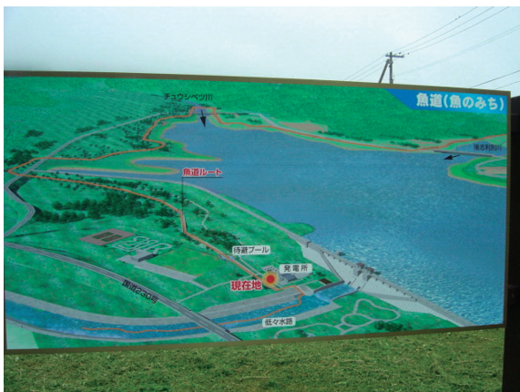
ダム（美利加ダム）に設置された長大な魚道
