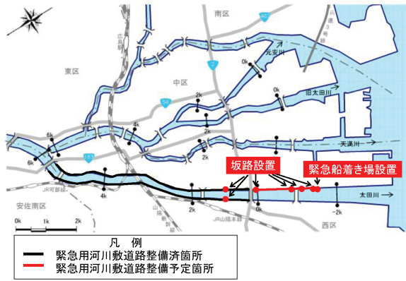
図4 緊急用河川敷道路整備計画（太田川水系河川整備計画，国土交通省中国地方整備局，2011）
