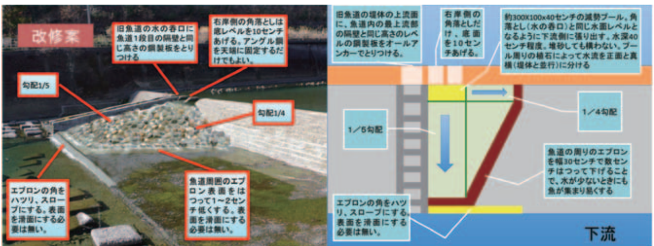
図8 小わざ魚道の施工説明シート例
