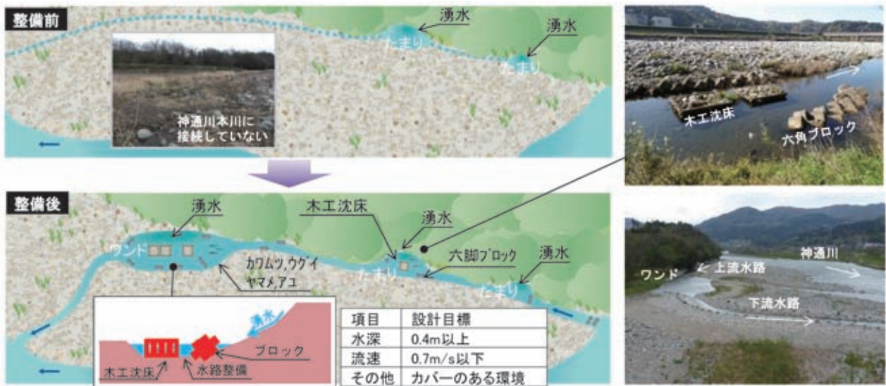
図-6 越冬場所（多自然流路の造成）整備イメージ（平成22年度施工 岩木新地先）
