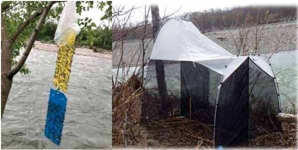
写真2 粘着トラップ(左)とマレーゼトラップ(右)
