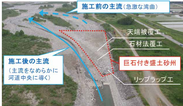
図-4 巨石付き盛土砂州による水衝部対策
