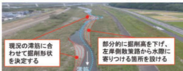
写真1 掘削実施時の配慮事項(五ヶ瀬川 8.6K 付近)
