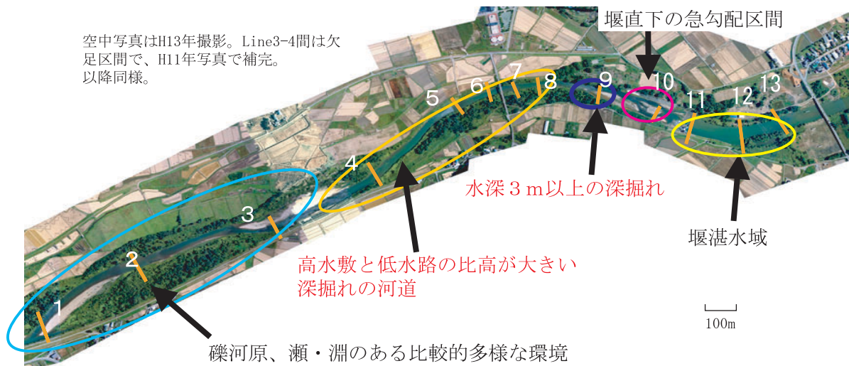
図-10 横断測量位置とその特徴
