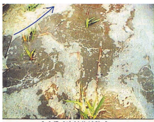
写真-4 六角川実験水路のヨシの倒伏範囲の拡がる状況
