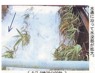
写真-4 六角川実験水路のヨシの倒伏範囲の拡がる状況
