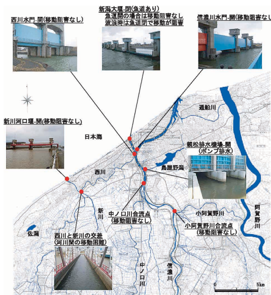
図-5 堰・水門による魚類移動阻害
