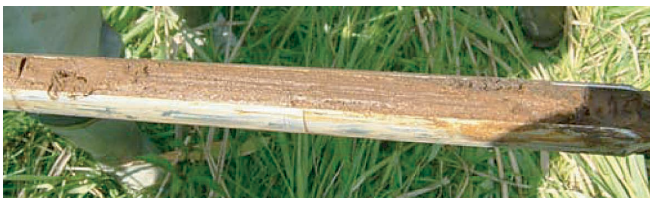
写真-8 第3調節池で確認された粘土質の土壤
