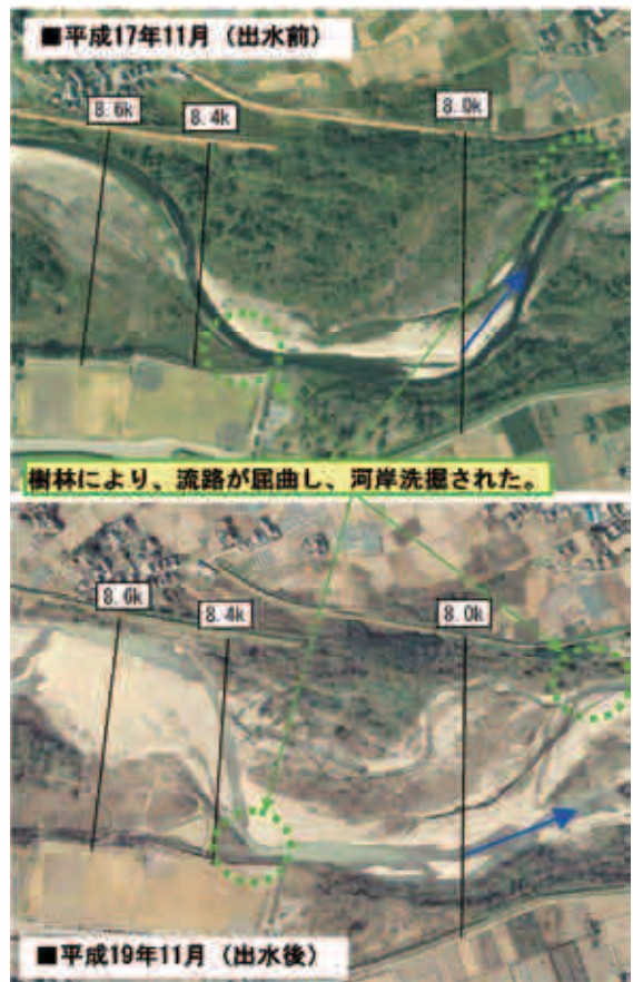
写真-2 H19.9出水に見られる河岸侵食の状況
