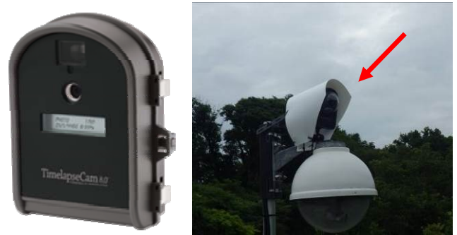
写真-4 インターバルカメラとその設置状況 (Wingscape 社製の TimelapseCam 8.0)
