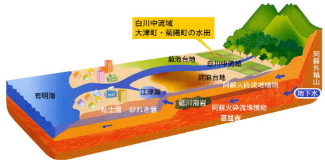
図-2 白川流域の地下水断面図（出典：水土里ネット大菊）
