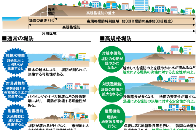
図-1 高規格堤防の基本断面及び機能 1)
