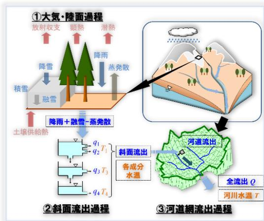
図-6 流域水循環モデルのイメージ
