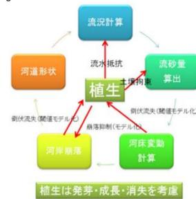
図-8 河畔林の動態を含めた水理モデルの構築
