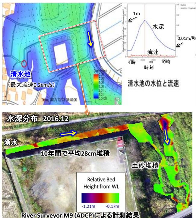
図-3 中流湧水域におけるハリヨの営巣微環境としての出水時の水深・流速分布 (IRIC 解析) と平水時の水深分布 (土砂堆積の動向)
