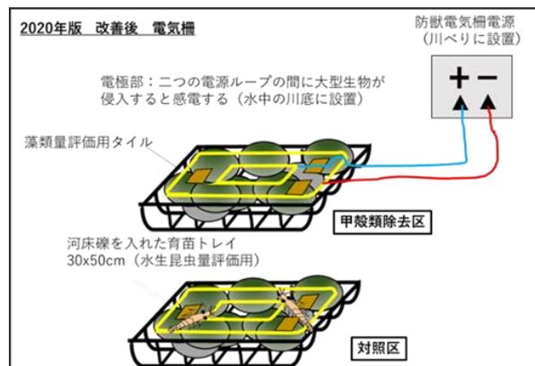
図2. 電気柵実験の概要
