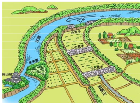
百間川の治水の仕組み(三段の荒手)
