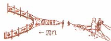
定置網を下流から上流に向かって遡上する魚類を採集できるように設置する。
