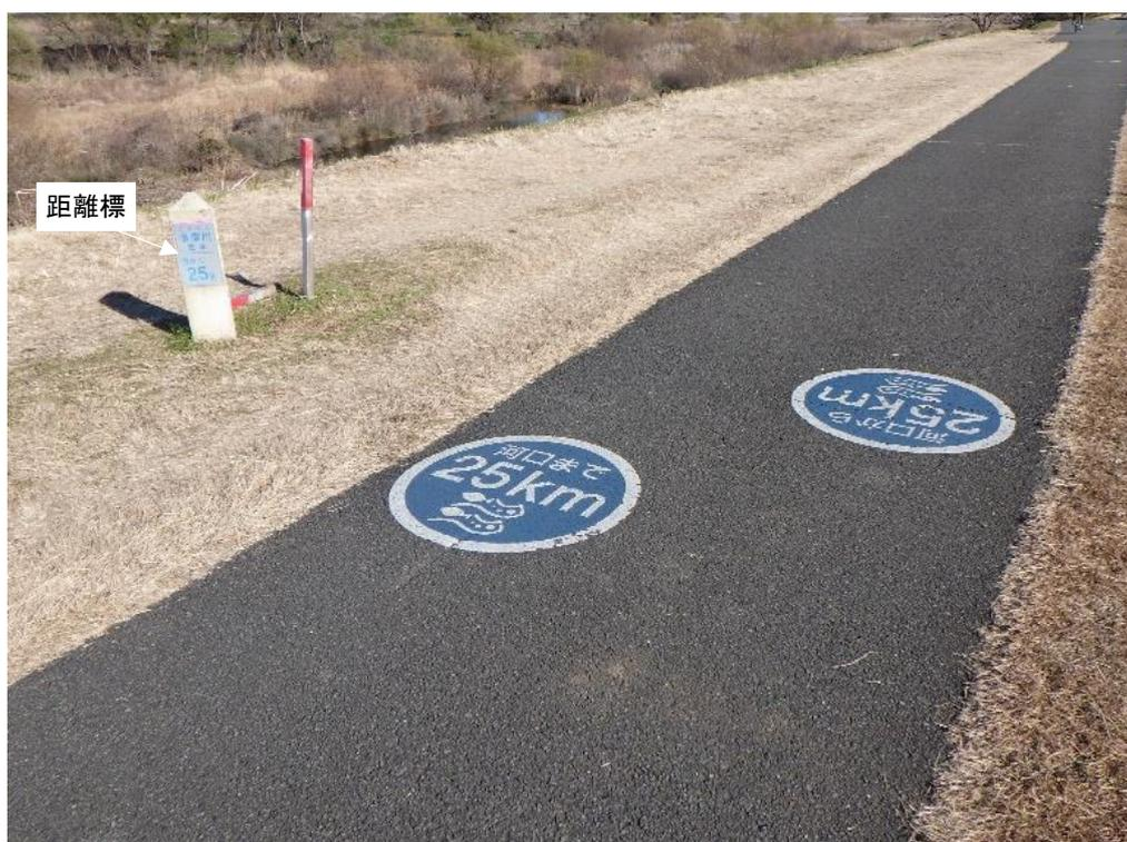
図 19 距離標と路面標示を併用した例 (多摩川 川崎市)
