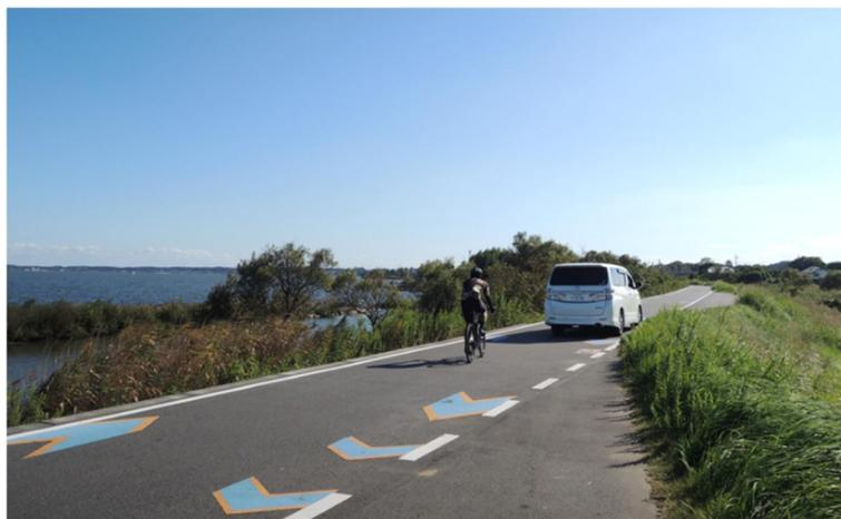
図 10 自動車混在道路に矢羽根印を設置した例
